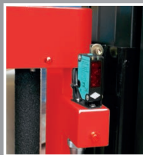
Fotocellula lettura pallet Photoeye to detect pallet height
